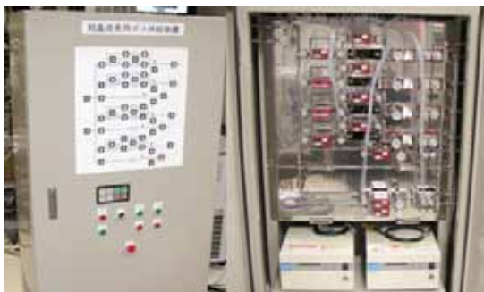
開発した有機金属気相エピタキシャル成長用ガスラインと制御用コンピュータ
